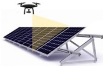
Figura 2 - Ilustração do procedimento para uma inspeção termográfica com UAV.
